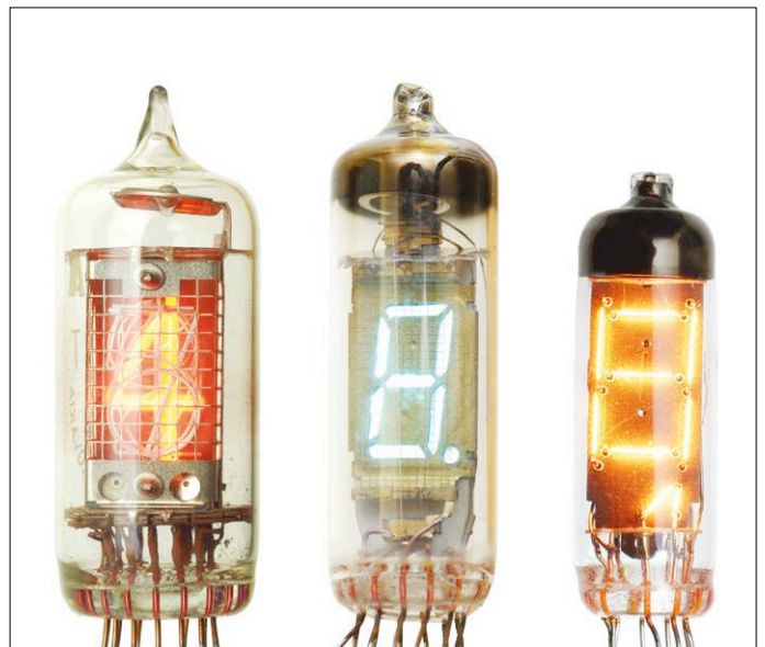
Figuur 2. Van links naar rechts: een Nixie-buis, een VFD en een Numitron.
